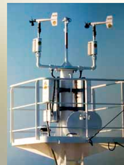
Sensores de envío en la embarcación "Alliance" de la OTAN. La embarcación cuenta con una estación meteorológica de Coastal que mide la velocidad/dirección/ráfaga/sigma theta del viento en tres puntos diferentes (a babor, a estribor, a popa).
