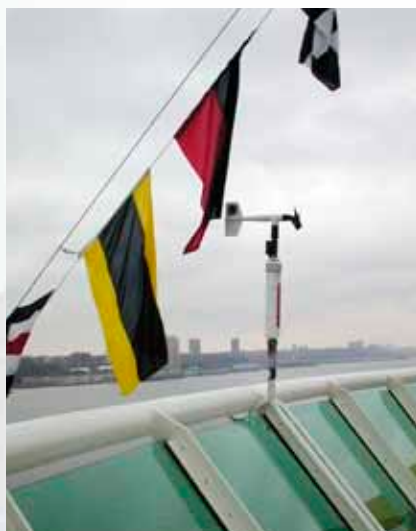
El sistema de tres puntos de este crucero presenta WEATHERPAK® a babor, a estribor y a popa.
